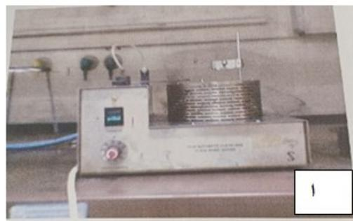
شكل 2: جهازي قياس درجتَي الوميض والانسكاب
