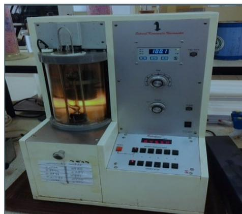
شكل 1. جهازي قياس اللزوجة Viscometer
